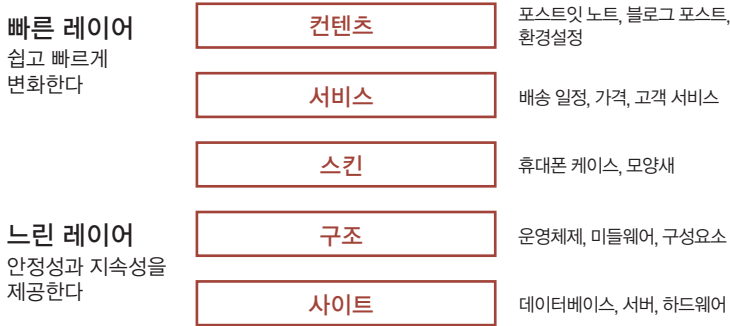
그림 7.10 스투어트 브랜드와 톰 모란의 연구에 기초한 다이어그램. 상단의 ‘빠른’ 레이어는 좀 더 빨리 변화하고, 하단의 ‘느린’ 레이어는 안정성을 제공한다. 상단 레이어에서 만들어진 변화는 시간이 지나면 아랫단으로 전파될 수 있다.
